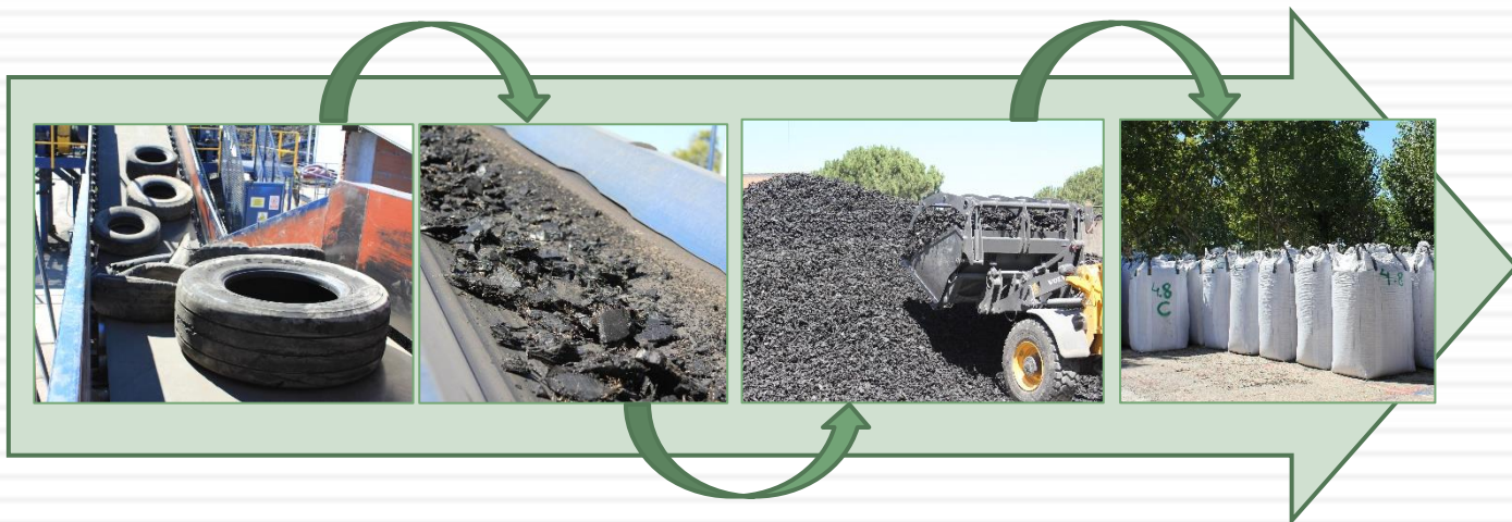
Proceso de transformación y acopio de los neumáticos a NFU's dentro de las instalaciones de GRP.
