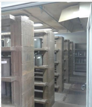
Probetas de hormigón en la cámara húmeda del Laboratorio en Sant Vicenç dels Horts.
