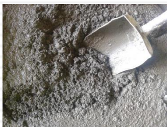
Aplicación de ariblack con cemento de aluminato cálcico para aplicaciones en pavimentos de alta resistencia a la abrasión y temperatura.
