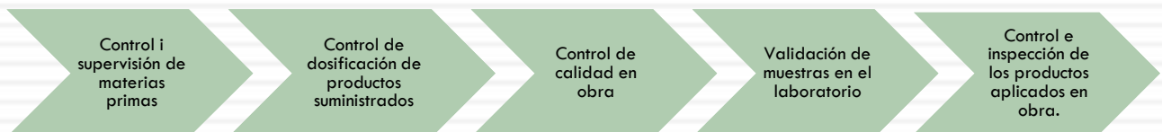
Esquema del control de calidad integrado en PROMSA.
