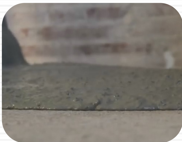
Propiedad autonivelante en detalle del PROSILENCE
