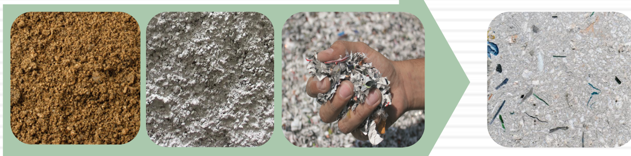
Arena, cemento y plasticos, elementos que componen el PROSILENCE
