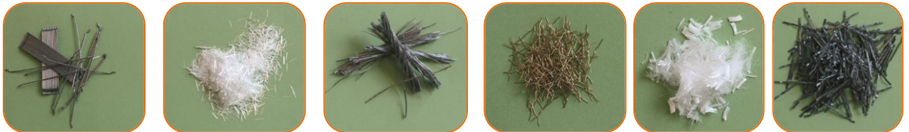
Ejemplo de los diferentes tipos de fibra que podemos adicionar al CAC.
