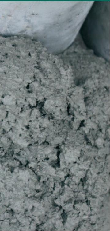
Diseñado para soportar las deformaciones originadas por la flexotracción de un elemento. Para conseguir sus particulares características, se dosifica la cantidad adecuada de cemento, y se seleccionan los áridos en función de su coeficiente de forma, índice de lajas y grado de limpieza.
