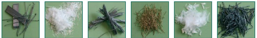
Fabricado con árido de 20 mm, como máximo, incorpora en su composición fibras de distintos tipos, que pueden ser de polipropileno, metálicas, de lana de vidrio, poliéster y poliméricas con el fin de reducir el riesgo de fisuras o aumentar la resistencia al impacto.
