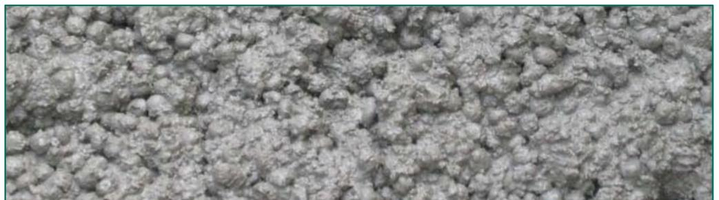
Fabricado con áridos de una densidad superior a los 3.000 Kg/cm<sup>2</sup>, está diseñado para que su peso específico supere los 2.800 Kg/m<sup>3</sup>.
