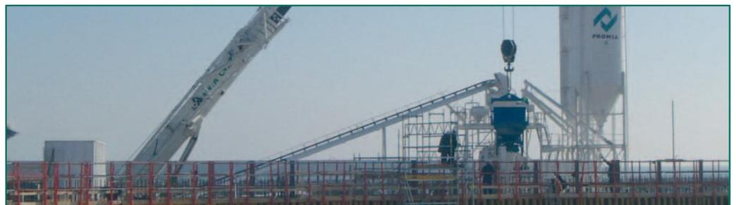
Mezcla de áridos, cemento, agua y aditivos, dosificada y amasada en una central de fabricación de hormigón. Su calidad le confiere las características de resistencia que cumplen los requerimientos legales específicos.
