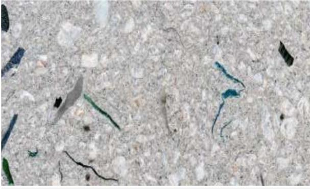
Prosilence Mix contiene material de origen reciclado. Este material proviene de residuos industriales previamente triturados de diferentes densidades, formados por: plásticos, caucho y textil. Esta mezcla de materiales está sometida a un estricto control de densidades y granulometría para garantizar la estabilidad y trazabilidad del producto. Estos materiales hacen que el Prosilence Mix sea más ligero, evitan las fisuras y le aportan mejoras térmicas y acústicas.
