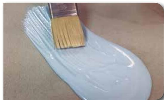
El espesor de cada capa debe ser de 0,4 mm. El espesor de la membrana en cualquier punto no puede ser inferior a 0,8 mm. El consumo de **PROPAM® IMPELASTIC** es de 1,3 Kg/m<sup>2</sup> y mm de espesor.
