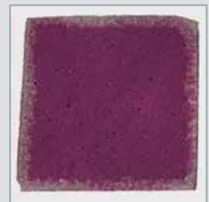
Frente de carbonatación en muestra estudiada
