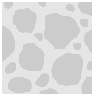
SUELO CEMENTO Granulometría de los áridos SC40, SC20 Contenido mínimo de cemento: 3% Índice de plasticidad < 15
