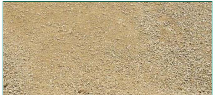
De granulometría continua, entre 0-20, 0-25 y 0-40 mm, es un material denominado natural o artificial, en función de si se somete un proceso de triturado o no.
