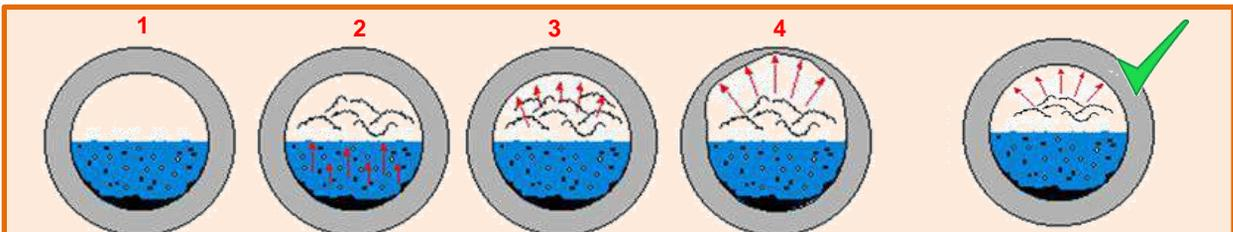
Podemos ver en la secuencia el ataque en el interior de una canalización de un colector por efecto de la formación de ácido sulfúrico. Los gases que se desprenden de la fermentación bacteriana, atacan las zonas aéreas.
