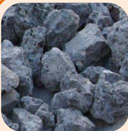
El árido siderúrgico es aquel árido procedente de la trituración de escorias siderúrgicas. Tiene propiedades específicas como: Alta resistencia a la abrasión, resistencia a la fragmentación (altamente resistente al impacto) y sobretodo destaca su alta densidad aparente: 1.690-1.820kg/m<sup>3</sup>. Además es un producto ecológico ya que procede 100% de material reciclado.
