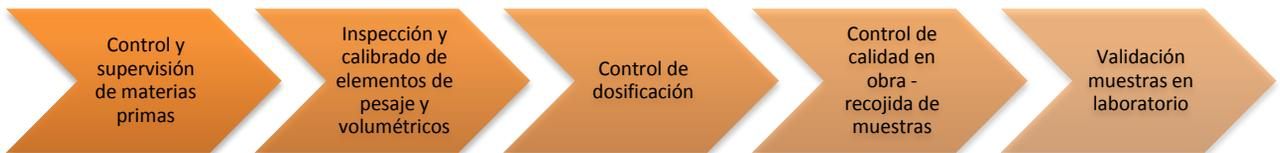
Esquema del control de calidad integrado.
