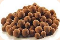
Los áridos ligeros aportan una densidad menor que los áridos naturales al hormigón (1200 a 2000 kg/m<sup>3</sup>) manteniendo las características de éste: resistencia térmica, resistencia química, rápida velocidad de fraguado y alta resistencia a la abrasión.
