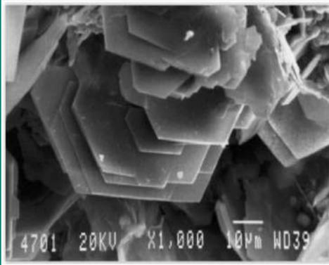
Vista de la estructura molecular del aluminato de calcio mediante microscopia electrónica de barrido
