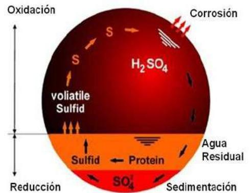
Proceso Red-OX dentro de un colector.
