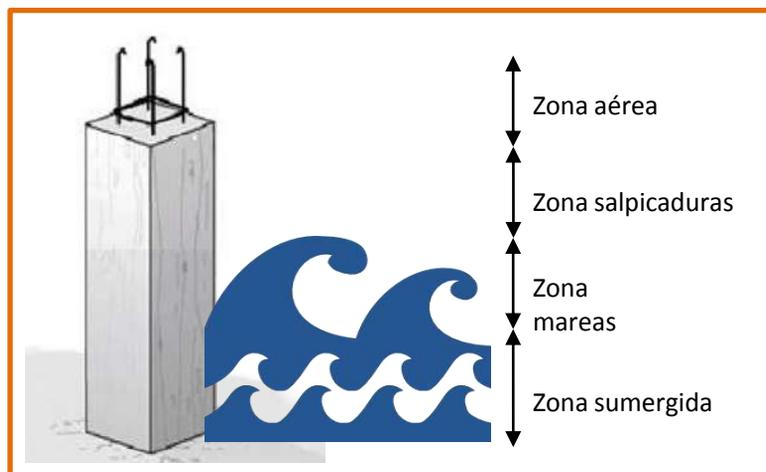
Los productos CAC fijan el ión cloruro en forma de cloroaluminato de calcio creando una barrera cristalina donde el ión cloruro no puede llegar a dañar las armaduras.
