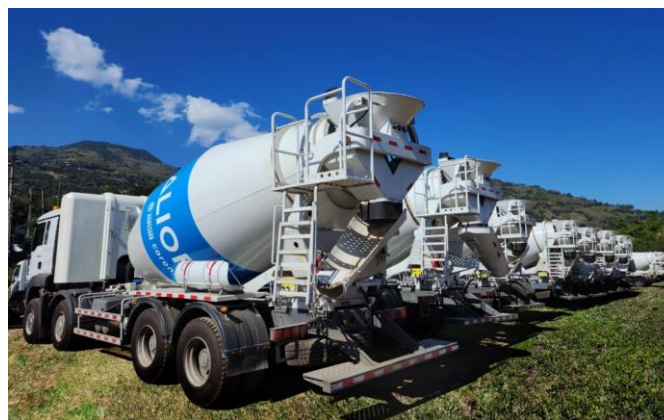
Camiones hormigonera con motor de gas (Colombia)
