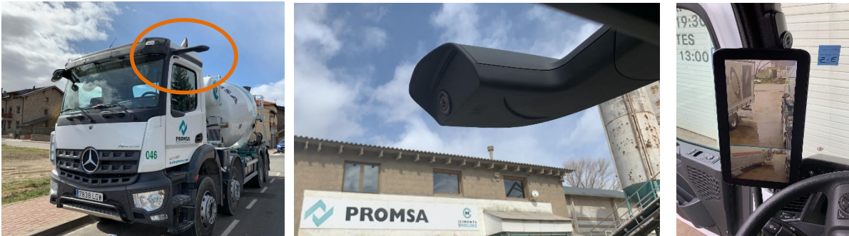
Detalle de las cámaras en los camiones hormigonera Mercedes en sustitución de los clásicos retrovisores.
